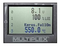
Unterstützt den Multiplex Sensor Bus (MSB) mit Rückmeldung der aktuellen ECU Messwerte an den Royal EVO, Profi TX oder Cockpit M-Link Sender. Das MPX Telemetrie Display Best. Nr. 45182 wird ebenfalls unterstützt.
